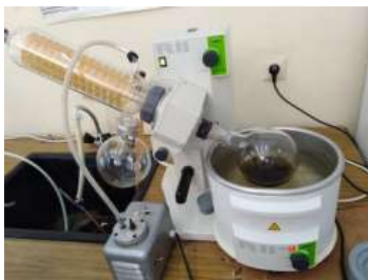
Figure 6: Évaporation de l'extrait méthanolique par le rotavapor
